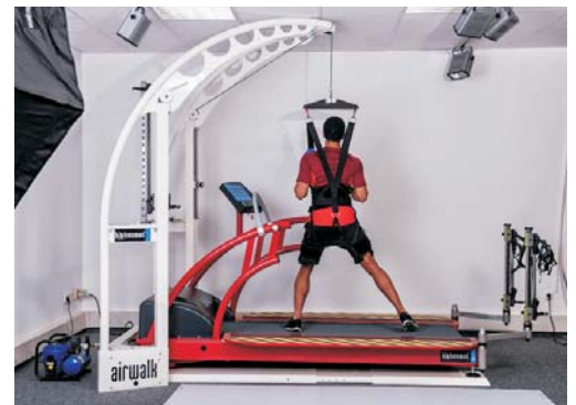
Airwalk ap ( blanco) con tapiz rodante Pulsar (rojo), tensores Robowalk y análisis diferencial de la pisada Optogait ( no visible)
